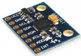
Figura 4. Acelerômetro e giroscópio de três eixos. Unidade MPU6050 [4] e circuitos de apoio.
